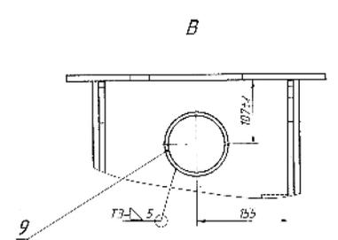
1. Сварку производить: обозначенных швов - электродами Э46 ГОСТ 9467-75, остальных - проводами СВ-08Г2С ГОСТ 2246-70. Остальные сварные швы по ГОСТ 14771-76.
