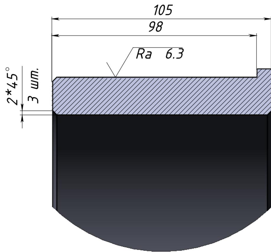
1. Согласовано допущение несоблюдения допусков диаметральных размеров, при соблюдении соосности колец
